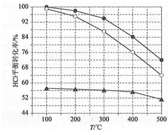
可知反应平衡常数  $K(300^\circ\text{C})$  \_\_\_\_\_  $K(400^\circ\text{C})$  (填“大于”或“小于”)。设 HCl 初始浓度为  $c_0$ ，根据进料浓度比  $c(\text{HCl}) : c(\text{O}_2) = 1 : 1$  的数据计算  $K(400^\circ\text{C}) =$  \_\_\_\_\_ (列出计算式)。按化学计量比进料可以保持反应物高转化率，同时降低产物分离的能耗。进料浓度比  $c(\text{HCl}) : c(\text{O}_2)$  过低、过高的不利影响分别是\_\_\_\_\_。
