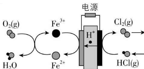
负极区发生的反应有\_\_\_\_\_ (写反应方程式)。电路中转移 1 mol 电子, 需消耗氧气 \_\_\_\_\_ L (标准状况)。
